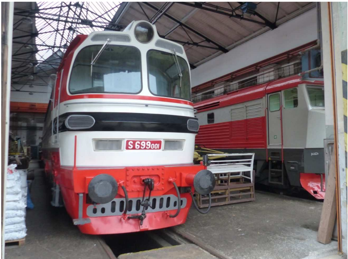
Prototyp elektrické univerzální lokomotivy S699.001
