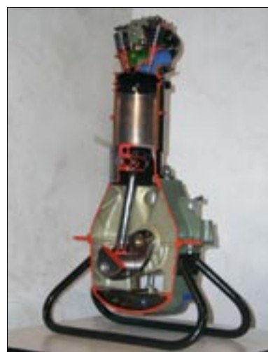
Model stojatého jednoválcového vznětového spalovacího motoru, vlevo před restaurátorským zásahem, vpravo po zásahu
