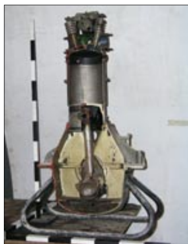
Model stojatého jednoválcového vznětového spalovacího motoru, vlevo před restaurátorským zásahem, vpravo po zásahu
